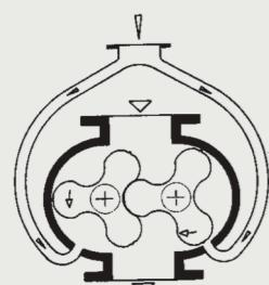
Si el gas bombeado es necesario recuperarlo o recomprimirlo, el gas enfriado debe ser aspirado de un intercambiador de calor conectado en serie en la impulsión de la bomba (Fig. 2).
