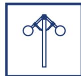
**Válvula de seguridad, de retención y de alivio con silenciador incorporado**
